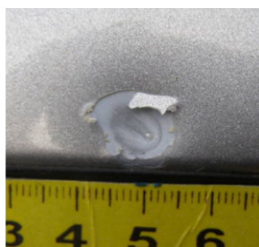
Рис. 3. Общий вид повреждения лакокрасочного покрытия кузова автомобиля
